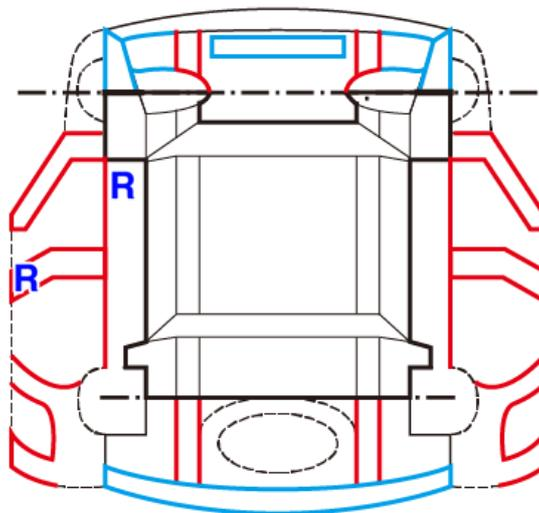
代號說明: R:有板金修復跡 X:有更換歷 B:有超過拳頭大之凹陷 S:生鏽
